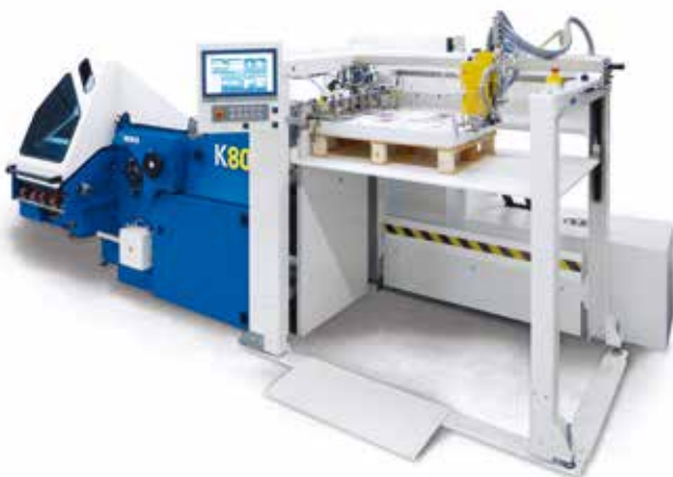
Automatisierte K80 mit Palettenanleger und M1-Steuerung Advanced.
