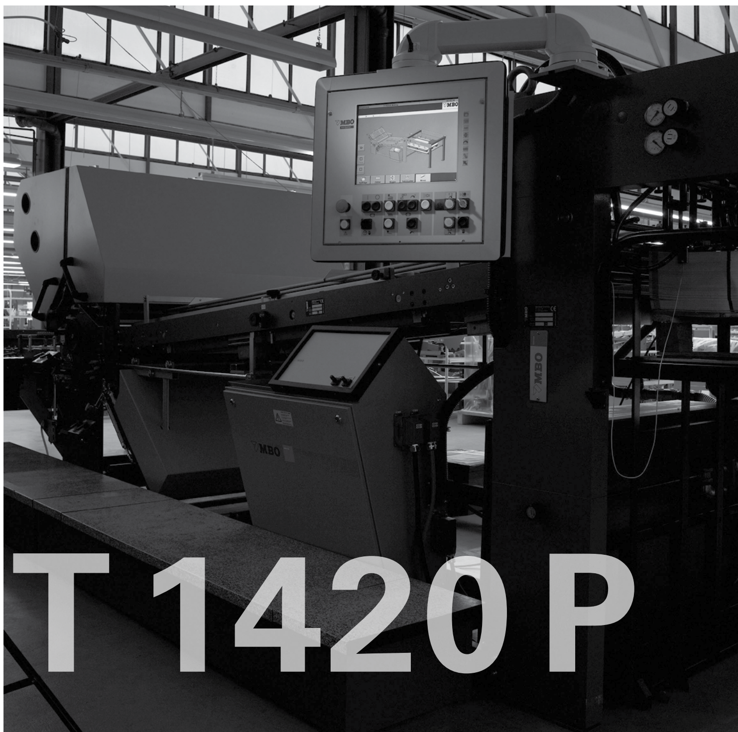
Margeur Mabeg T 1420P 4/4/4, NAVIGATOR-Control, groupe de pliage III avec dispositif de retour de feuilles RFE, sortie SBAP 82 ME
